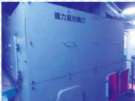
⑦この磁力選別機にて、スチールとアルミ等に選別します。
