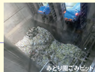
みどり園ごみピット ピットにごみを排出しています。
